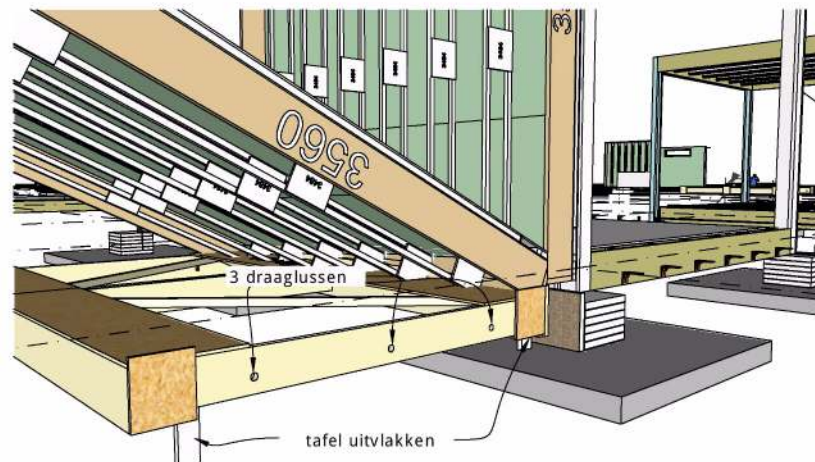
Gebruik montage tafel, opzetten gevel met 2 handlieren
